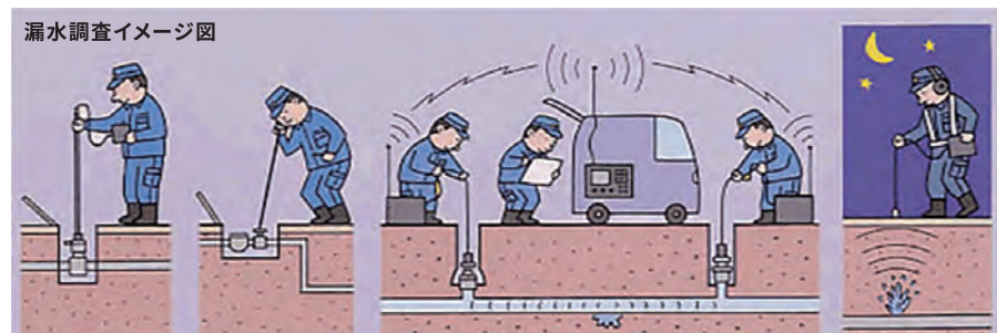
漏水調査イメージ図 ●時間積分式漏水発見器による調査 ●棒状音聴器による調査 ●相関式漏水発見器による調査 ●電子式漏水発見器による調査
